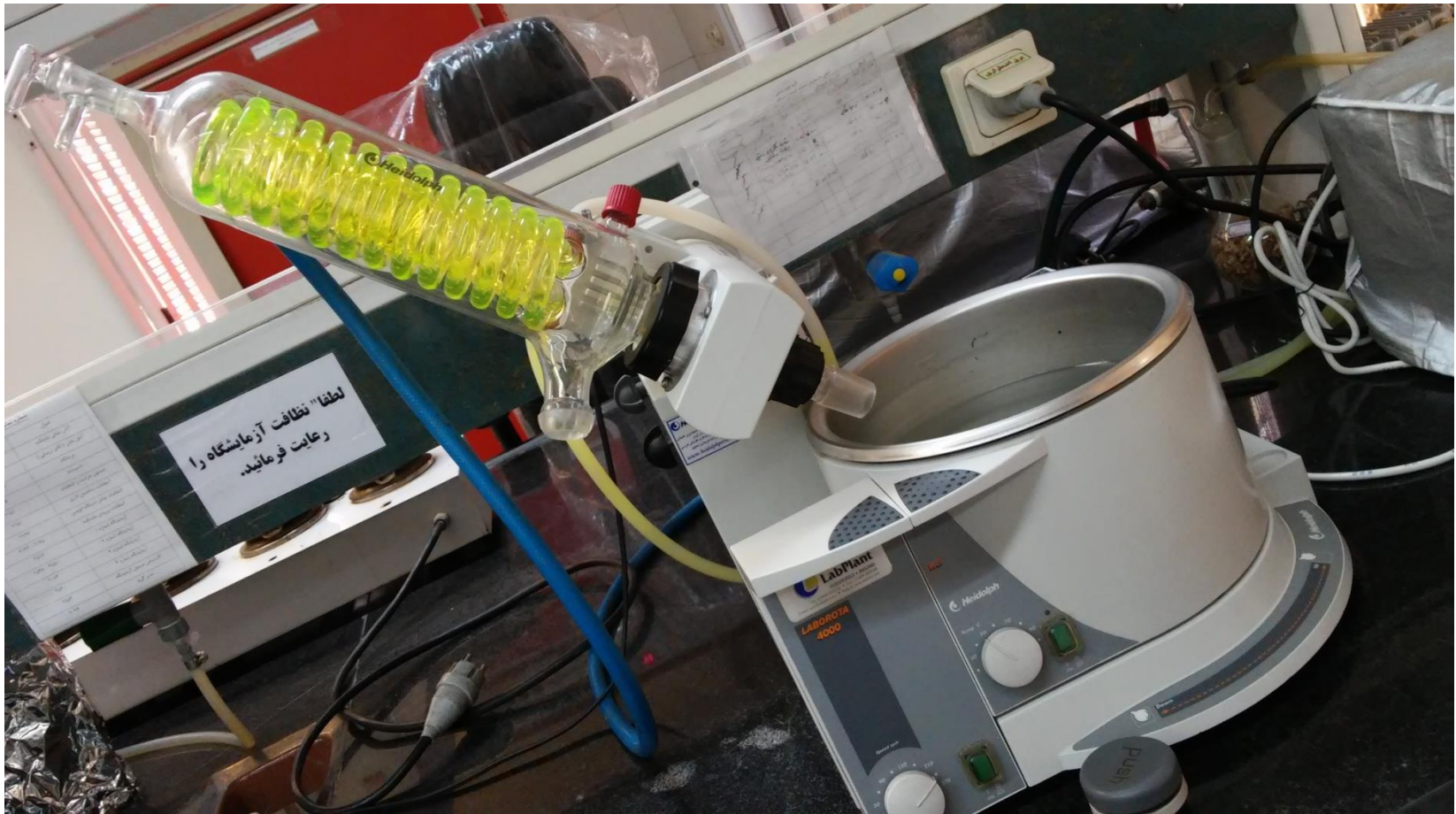
Rotary Evaporator جداسازی حلال از ترکیبات مختلف
