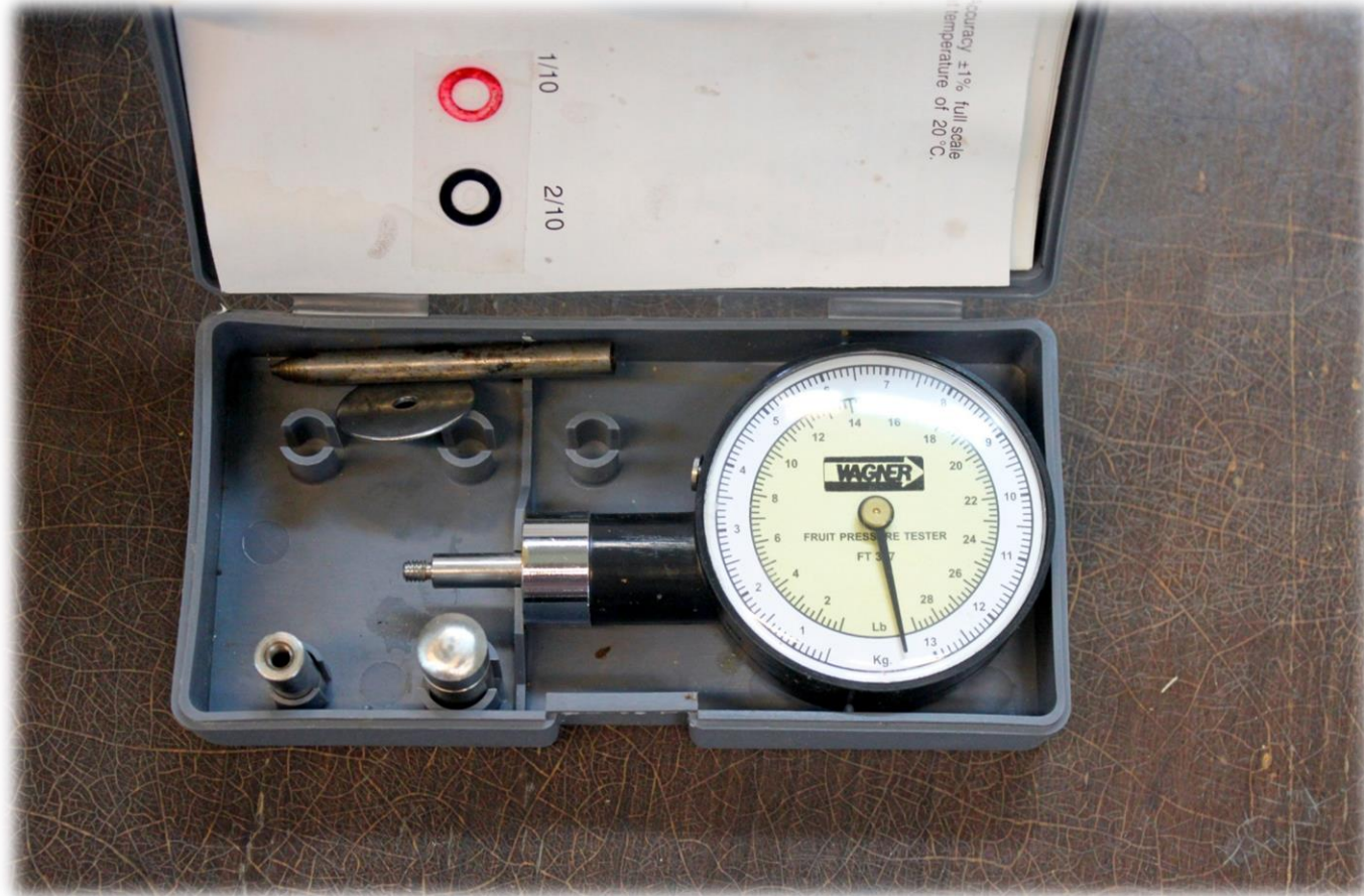
Penetrometer اندازه گیری سفتی بافت
